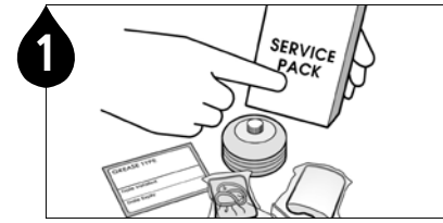
1 그리스 파우치 및 구성품 (배터리팩, 그리스 파우치, 더스트 커버, 메모 라벨)을 확인 합니다.
