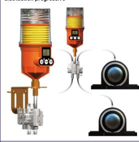
Il est possible d'effectuer une lubrification multipoint à distance avec le Pulsarlube M à l'aide d'un bloc diviseur. Il est recommandé de tester la contre -pression du roulement, des lignes de lubrification et du bloc diviseur une fois l'assemblage terminé à l'aide d'une pompe de graissage relié e à un indicateur de pression. Assurez-vous que la pression de rupture est inférieure à la pression de fonctionnement moyenne de 30kgf/cm² (425 psi).
