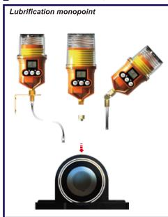
Un montage linéaire/tronqué direct (avec ou sans tube d'extension) est toujours préférable. Cependant, pour les applications ne permettant pas de montage direct ou d'extension, vous pouvez réaliser un montage à distance de l'unité à l'aide d'une ligne de lubrification pré-chargée d'un diamètre extérieur de 6mm (1/4").
