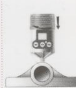
6) Atornille la cubierta superior.
